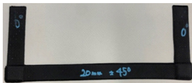
図1 製作した一体型CFRP製トーションバー
