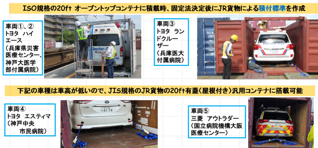
図5 各種ドクター・カーを、2種類のコンテナにそれぞれ異なった方法で固縛
